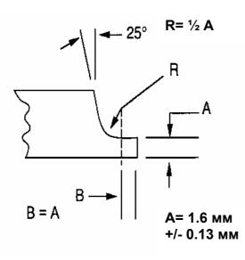
Предпочтительной разделкой для орбитальной сварки труб с толщиной стенки более 4мм является "Ј образная " разделка. В большинстве случаев для углеродистых сталей и сталей класса 316, 304 и аналогичных наилучшие результаты могут быть достигнуты в случае, если размеры разделки будут соответствовать представленным на рисунке для труб с толщиной стенки до 13 мм.
