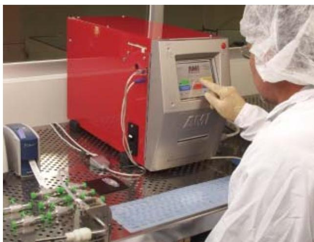
Сварочные параметры могут быть заданы как в функции времени, так и в функции углового положения вольфрамового электрода.
