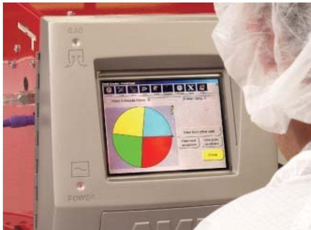
В процессе сварки, реально измеряемые параметры могут отображаться не только в виде цифровых значений, но и в виде графиков, благодаря чему какие либо отклонения от заданных значений легко обнаруживаются.
