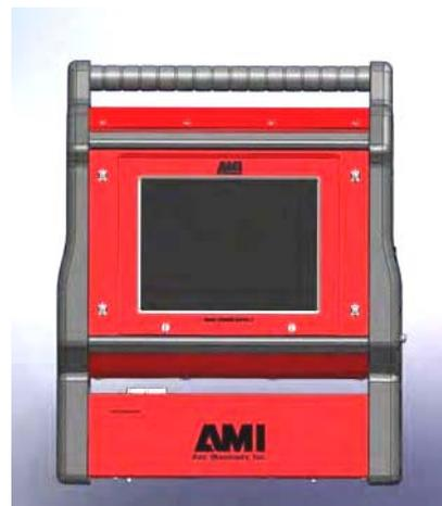
Эта модель может быть использована для сварки любых материалов, поддающихся сварке неплавящимся электродом в среде защитного газа (TIG) на постоянном токе.
